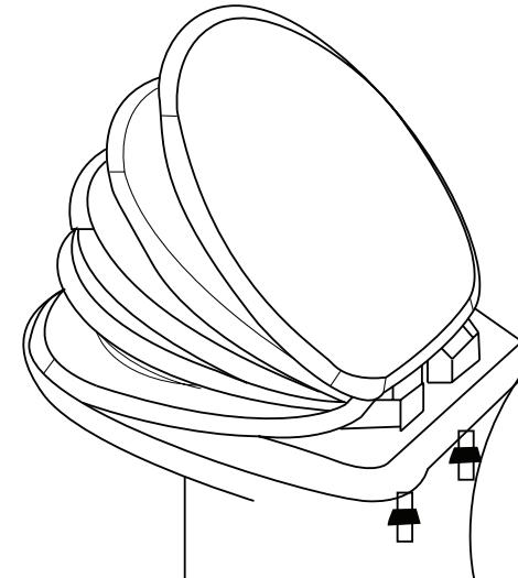
Drücken Sie den Toilettendeckel nicht herunter um den Schließvorgang zu beschleunigen. Dies kann zu Schäden an der Absenkautomatik führen.
