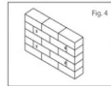
③ Legen Sie die Halterung zur Seite und bohren ein 8mm Loch an jeder markierten Stelle. Entfernen Sie alle Rückstände von Staub und Schmutz aus den Löchern.
