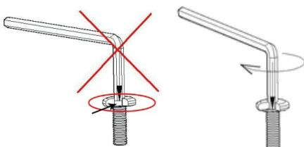
Si vous ne le faites pas et que vous glissez hors de l'échancrure, ça engendrera des dommages sur la vis, lesquelles peuvent conduire à fausser l'intérieur la tête de vis, ce qui aura pour conséquence d'empêcher toute prise avec la clé Allen. Les têtes de vis faussées ne sont que le résultat de cette mauvaise manipulation et ne sont pas un objet de réclamation.
