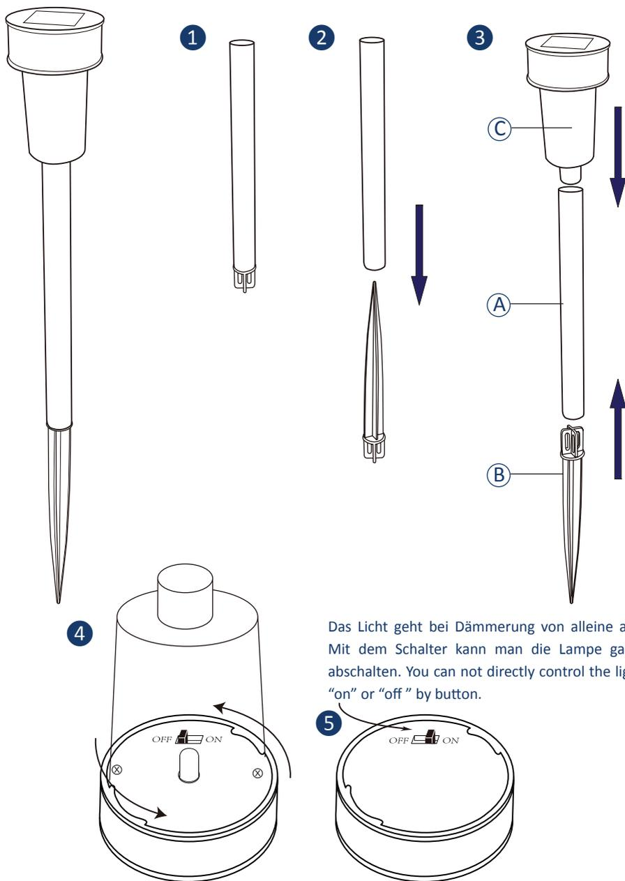
Das Licht geht bei Dämmerung von alleine an. Mit dem Schalter kann man die Lampe ganz abschalten. You can not directly control the light "on" or "off" by button.
