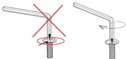
Wenn Sie dies nicht tun und aus der Schraube abrutschen, wird die Schraube Schaden nehmen und es kann dazu kommen, dass der Schraubenkopf innenseitig rund wird und Sie mit dem Sechskantschlüssel keinen Halt mehr finden. Rund gedrehte Schraubenköpfe resultieren nur hieraus und sind kein Grund für eine Reklamation.
