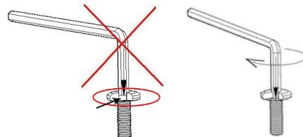
Si vous ne le faites pas et que vous glissez hors de l'échancrure, ça engendrera des dommages sur la vis, lesquelles peuvent conduire à fausser l'intérieur la tête de vis, ce qui aura pour conséquence d'empêcher toute prise avec la clé Allen. Les têtes de vis faussées ne sont que le résultat de cette mauvaise manipulation et ne sont pas un objet de réclamation.
