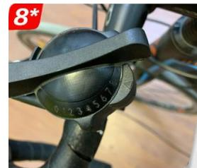
8° Passo: Installazione del controllo filo Montare il controllo a filo in qualsiasi punto sul manubrio, il diametro di un punto installato deve essere inferiore a 3 cm. Il nuovo filo può mettere a punto la resistenza. È più pratico..
