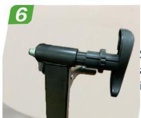
Schritt 6: Überprüfen Sie erneut, dass beide Seiten fest angezogen sind. Anschließend stellen Sie den Feststellknopf in die gleiche Richtung wie der Rahmen ein.
