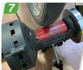
7° Passo: Regolare il regolatore di pressione finché non tocchi il pneumatico. La tenuta del regolatore di pressione determina la resistenza. Più è solido, maggiore è la forza
