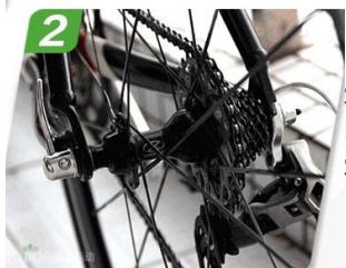
Schritt 2: Ersetzen Sie den Schnellspannhebel der Hinterachse Ihres Fahrrads durch den mitgelieferten Schnellspannhebel des Bike-Trainers.
