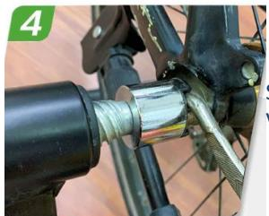
Schritt 4: Halten Sie die linke Seite der Hinterachse in Verbindung mit dem linken Bajonett des Bike-Trainers.
