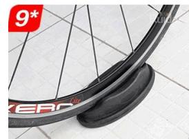
Schritt 9: Der Unterlage für das Vorderrad wird verwendet, um das Schwingen des Fahrrads zu verhindern.
