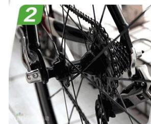
2° Passo: Sostituire la leva di sgancio rapido dell'assale posteriore della bici con la leva di sgancio rapido in dotazione del bike trainer.
