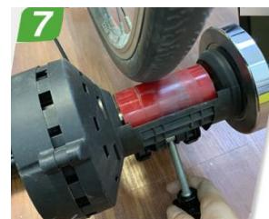
Schritt 7: Stellen Sie den Druckregler ein, bis er den Reifen berührt. Die Dichtheit des Druckreglers bestimmt die Widerstandskraft. Je fester, desto größer ist die Kraft.
